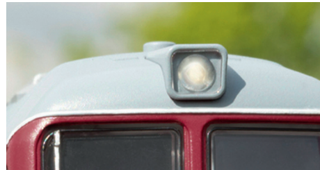
Stirnlicht oben, dem Spitzensignal in dieser Richtung zugeschaltet
