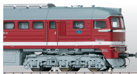
Achsfolge Co'Co', hier ein Drehgestell und die angesetzte Schürze (statt Kupplung)
