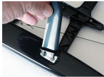
An den Rümpfen ist der Kiel einfach zum Einstecken
