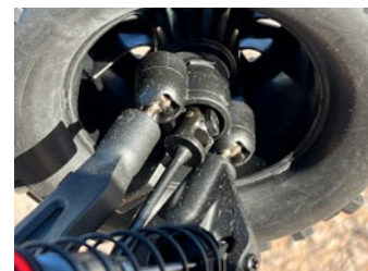
Die CVDs sorgen für eine perfekte Kraftübertragung
