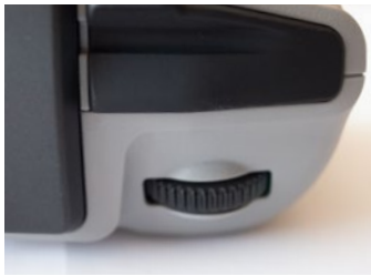
Steuerrad für den Gimbal-Motor: auf und ab
