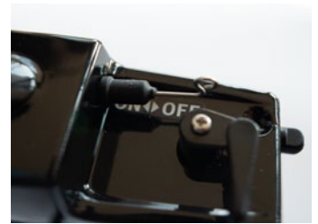
Der An-/Aus-Schalter ist gut positioniert. Rechts ein Gummistopfen zum Ablassen von in den Rumpf eingedrunenem Wasser
