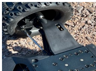
Die im Text erwähnten massiven Querlenker vorne...
