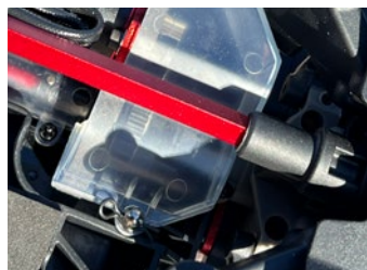
Die Abdeckung über dem Hauptgetriebe und dem Slipper
