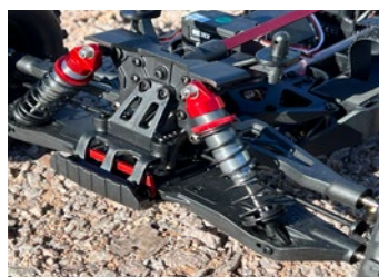
Die massiv ausgeführte Vorderachse
