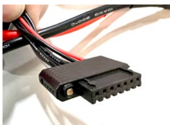
Der G-Tech Balancer Stecker am Akku
