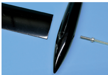
Das Stabilisierungsgewicht sowie der Kiel werden mit Gewindeschrauben fixiert
