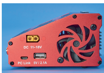
Großzügig dimensionierter Lüfter auf der rechten Seite
