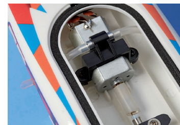
Die Wasserkühlung des Motors war bei unseren Testfahrten nicht sehr wirksam
