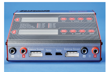
Anschlussterminal für zwei Akkus
