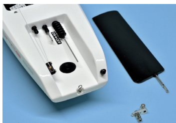
Gummitüllen machen dicht, trotzdem gibt es einen Wasserablassstöpsel
