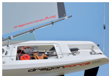
Per Dual-Rate wird der Schotweg eingestellt. Passt alles, werden die Knoten gesichert
