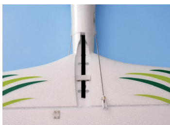
Einfache Montage der Leitwerke durch Vierkant am CFK-Rohr
