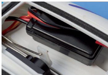
Die Regler-/Empfängereinheit ist in einer Box vor Spritzwasser geschützt
