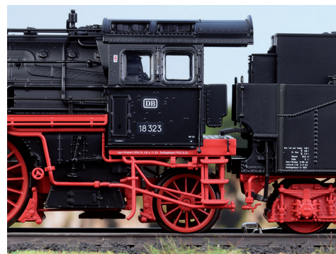
Die Seitenansicht der 18323 im Maßstab 1:87 zum Vergleich mit dem Vorbildfoto unten. Der vergrößerte Lok-Tender-Abstand ist ein Tribut an enge Modellradien, lässt sich...
