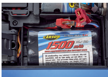
Der 2s-Li-Ion-Akku mit 1500 mAh ist bei Lieferung schon im Truggy
