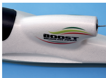
Antrieb ist bis auf Luftschraube und Mitnehmer fertig montiert
