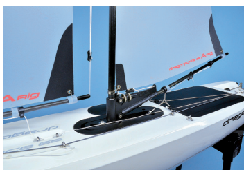
Die Neigung des Großbaumes kann justiert werden. Wie stramm soll das Segel sein?
