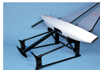
... und gekippt für Wartung des Kiels oder zum Transport (nur 60 cm hoch)
