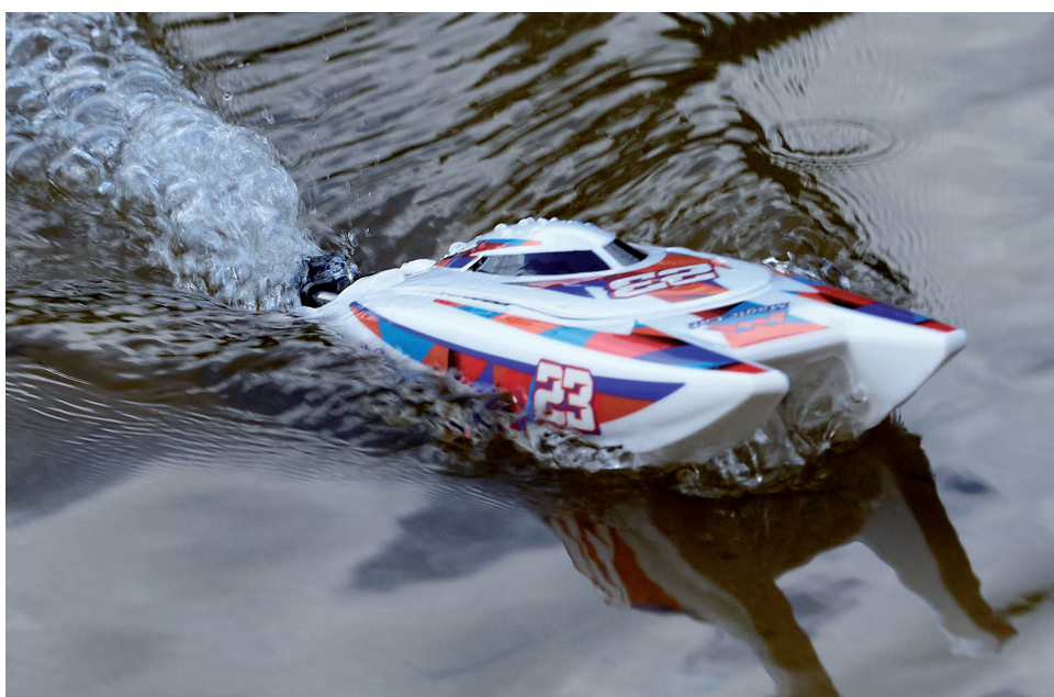
Offset-Ruderanlage, Zweiblatt-Propeller und fest eingestellte Trimmklappen am Heck
