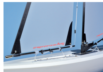
Das Focksegel kann vielfältig getrimmt werden, das Gegengewicht sorgt für leichtes Ausrichten
