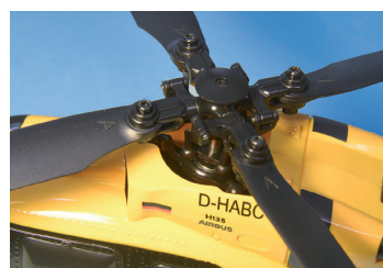
4-Blatt-Rotorkopf, 3-Punkt/120-Grad-Servoanordnung betätigt Taumelscheibe
