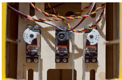
Für das Höhenruder werden zwei Servos benötigt, das Seitenruder ist mit einem zufrieden
