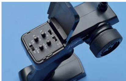
Kommandozentrale: Am Sender lassen sich sogar Dual-Rate für Gas und Lenkung einstellen
