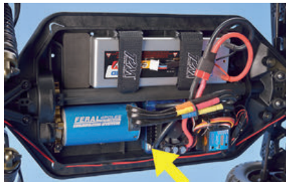
Hier wird der Regler scharf geschaltet!
