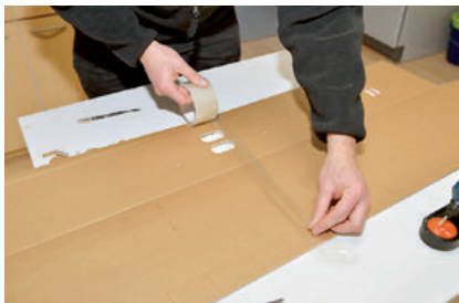
Zur exakten Positionierung der Flächenhälften werden diese vor dem Verkleben mit Paketband provisorisch zusammen geheftet
