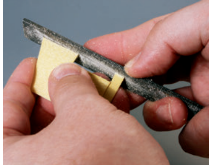
Mit einer Feile oder feinen Raspel werden etwaige Unebenheiten an den Schnittkanten eliminiert ...
