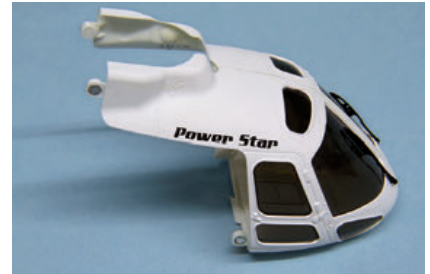
Das Rumpfvorderteil wird mit vier Magneten elegant befestigt
