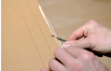
Für einige Verbindungen sind möglichst exakte Gehrungsschnitte nötig
