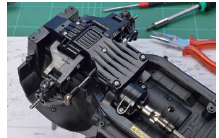
Jetzt ist auch schon das Lenkgestänge montiert
