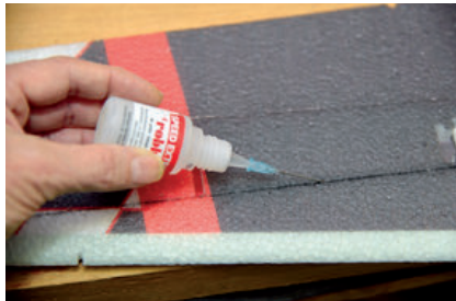
Sind die Flächen gerichtet, wird der dünne CA-Kleber mittels Kanüle in die Schlitzte gefüllt
