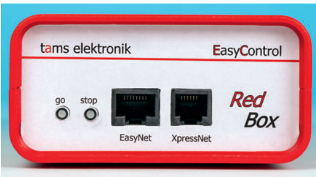
Die Front der RedBox mit den Anschlüssen für das EasyNet und das XPressNet sowie den Tastern „Stop“ und „Go“. An der Rückseite befinden sich die Buchsen für die Stromversorgung, USB-1 und USB-2 sowie für den s88-N-Bus, Gleis, Programmiergleis sowie Booster ...
