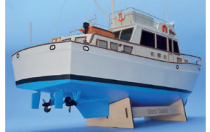
Zwei Motoren und eine Doppelrudanlage sorgen für gute Fahrleistungen und Steuerbarkeit
