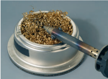
Gegenüber feuchten Schwämmchen bieten Abstreifschwämme aus Metall den großen Vorteil, dass die Lötspitze beim Säubern nicht auskühlt
