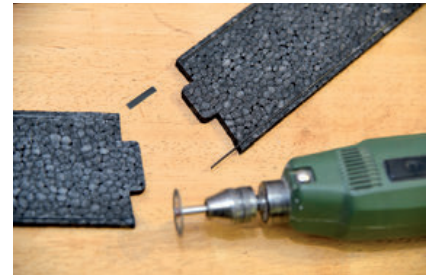
Die Kohleverstärkungen der Flächenstreben werden der Anleitung entsprechend gekürzt
