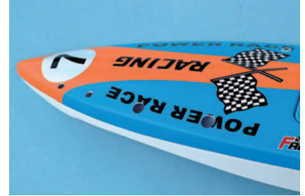
Borungen zum Fluten des Aufrichtkanals. Das Design ist aufgedruckt!
