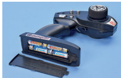
Der Pistolengriff-Sender ist mit vier Zellen der Mignon-Größe zufrieden
