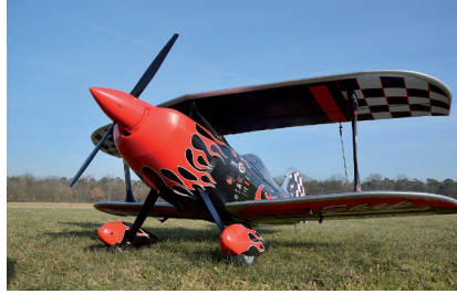
Die markante Front hilft bei der Lageerkennung. Der Propeller muss ausgewuchtet werden
