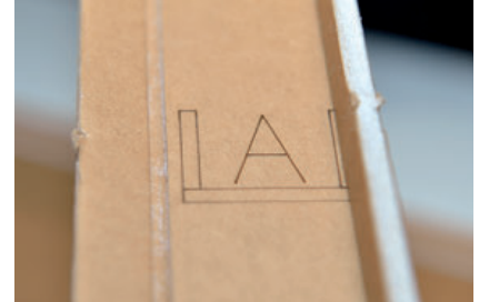
Wie die einzelnen Platten zusammengefügt werden sollen, ist eingefräst
