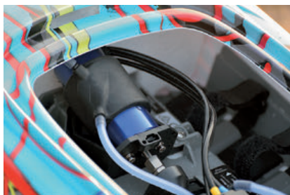
Trotz ruhiger See ist innen alles nass. Der Silikonmantel um den Motor ist nicht dicht
