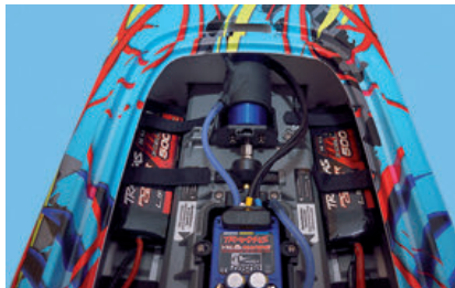
Für die beiden 11-Volt-LiPos gibt es Markierungen und Hinweise für die richtige Position
