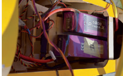
Die Bucker hat eine große, von oben abnehmbare Cockpitabdeckung für einfachen Akkuwechsel
