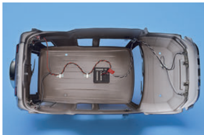
Das Lichtset ist jetzt fertig montiert
