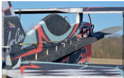
Gedrucktes Design auf dem Kreuz-Silhouetten-Rumpf. Die CF-Anlenkungsstäbe sind gut geführt und können sich nicht verbiegen
