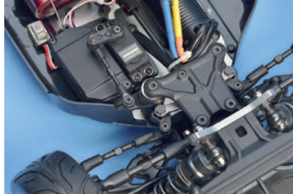
Kräftig und schnell: Das digitale Lenkservo hat ein Metallgetriebe
