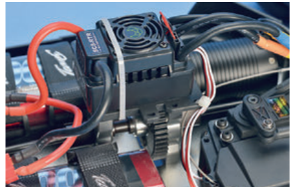
Der Regler wird von einem aktiven Lüfter wirksam gekühlt
