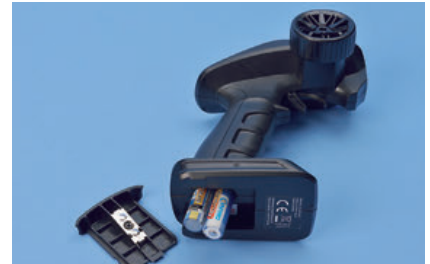
Der Sender ist mit zwei AA-Batterien oder Akkus zufrieden
