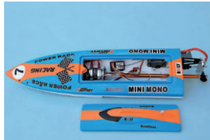
ABS-Rumpf mit Flutkanal und großem Deckel
