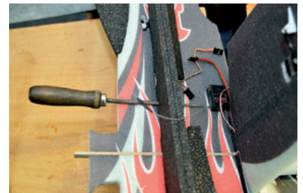
Servokabellängen legen die Position des Empfängers fest. Die Antennenführung ist vor dem Verkleben der oberen Fläche zu berücksichtigen
