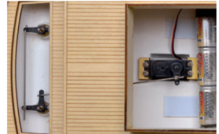
Das Lenkservo und dessen Anlenkungsgestänge
