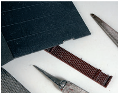
Damit das Dach des Anbaus an der Außenwand des Faller-Gebäudes endet, wird eine Einkerbung angelegt
