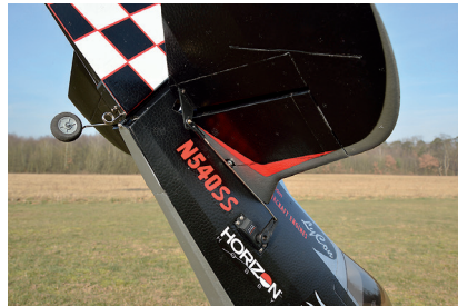
Unübliche Z-Anlenkungen in der Modellklasse. Spielfreie Kugelgelenke sollten überall sein
