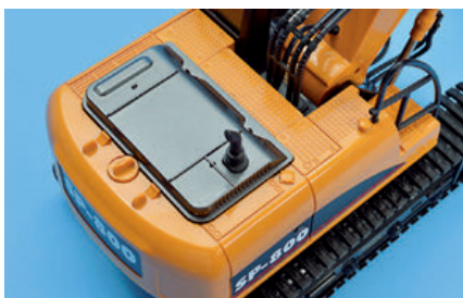
Unter der „Motorhaube“ verbirgt sich der Akkupack für den Antrieb
