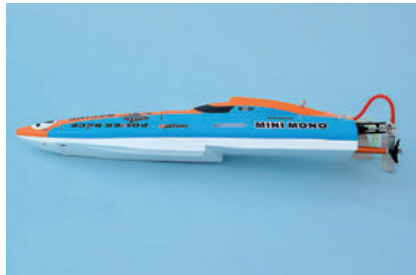
Seitenansicht: Der Stufenrumpf reduziert den Widerstand beim Gleiten
