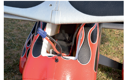
Der 22,2-V-LiPo ist mit Klettband fixiert und Schlaufe gesichert. Das hält!
