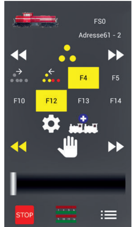
Ein weiteres Beispiel für ein Fahrpult mit seinen verschiedenen Symbolen. Am unteren Rand findet man die Symbole zum Umschalten auf andere Bereiche wie zum Beispiel hier das Keyboard und das Hauptmenü
