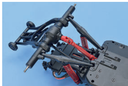
Die hintere Starrachse erlaubt eine immens hohe Verschränkung
