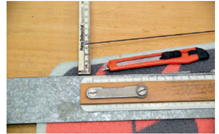
Die Tragflächen müssen geritzt werden, um beidseitig 1,2-mm-Kohlestäbe aufzunehmen
