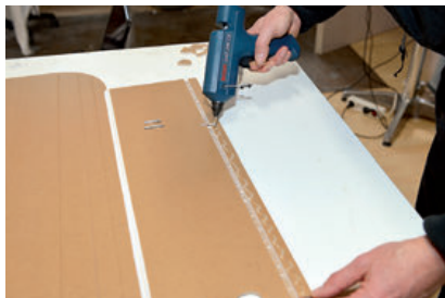
Hier muss man zügig arbeiten, damit der Kleber nicht kalt und hart wird, bevor die Bauteile zusammengefügt sind
