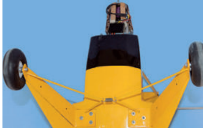
Das robuste Fahrwerk mit großen Rädern ist gefedert
