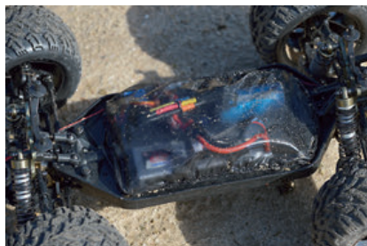
Das Netz schützt die Elektronik wirksam vor Schmutz und Feuchtigkeit
