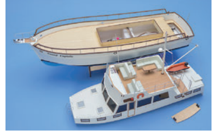
Das Deck ist nur aufgesetzt. Im Rumpf verbirgt sich die Technik unter der großen und gut zugänglichen Luke
