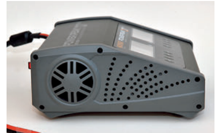
Seitliche Belüftung durch verschiedene Lüftungsöffnungen in den Kunststoffdeckeln
