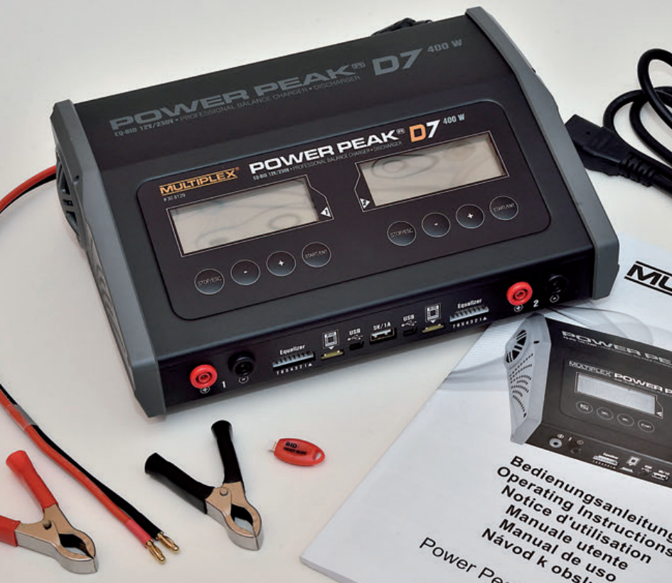
Übersichtliches Zubehör. Ladekabel, BID-Keys und Balancer-Boards müssen separat bezogen werden. Vier Folien-Taster reichen für die Einstellungen, zum Starten und Überwachen der Ladevorgänge
