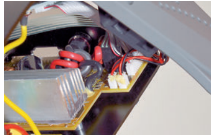
Dicke Kabel und gesicherte Steckkontakte für sorgenfreies Laden/Entladen
