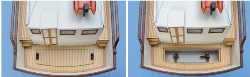
Unter der kleinen Luke am Heck ist das Gestänge des Lenkservos für Wartungsarbeiten gut zugänglich
