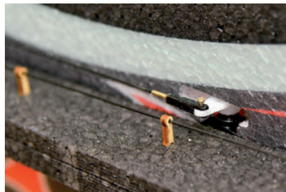
Für eine spielfreie Anlenkung müssen die Ruderhörner mit 0,9 mm aufgebohrt werden
