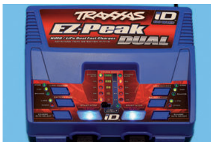
Der Doppellader informiert über hell leuchtende LEDs. Die Balancer-Anschlüsse für „normale“ LiPos sind abgedeckt
