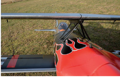
Der Baldachin besteht aus Kunststoff-Formteilen. Die Haube öffnet sich auf Knopfdruck
