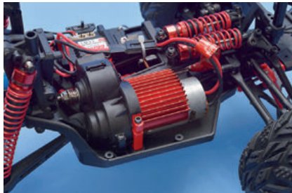
Für Vortrieb sorgt der 380er Brushed-Motor. Er wird durch eine Slipper-Kupplung vor Überlastung geschützt
