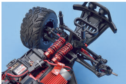
Detail der Vorderachse: Liegend eingebaute Stoßdämpfer mit Umlenkung kennen wir sonst nur von flachen Formel-Wagen
