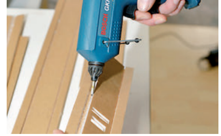
Sämtliche Verklebungen werden mit der Heißklebepistole durchgeführt
