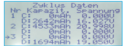
Bis zu zehn Zyklusdaten können angezeigt werden. Zum Löschen muss ein anderer Akku gewählt werden
