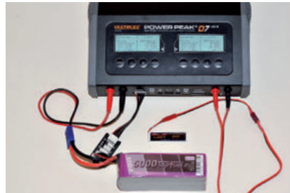
Dick und klein im Parallelbetrieb. 1 bis 7 Li-Zellen können mit 0,1 bis 20 Ampere geladen werden
