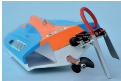
Großzügige Öffnung des Flutkanals. Steuerung in Alu
