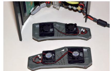
Im Inneren werkeln insgesamt vier Lüfter, die nach Bedarf Fahrt aufnehmen und deutlich zu hören sind
