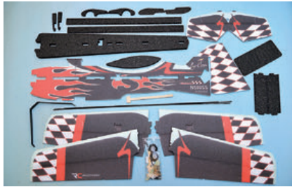
Sauber geformte und gefräste EPP-Formteile. Kohlestäbe für Steifigkeit und erforderliche Kleinteile
