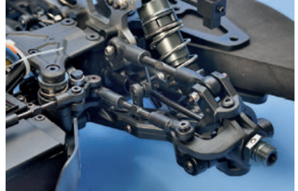
Das Fahrwerk ist über R/L-Gewindestangen präzise einstellbar
