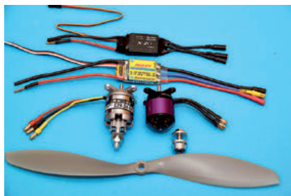
Antriebsvarianten Hacker A20-20L/1022KV & X30Pro (nicht X20!) oder Roxxy C28-34-08/1120 & BLC 930
