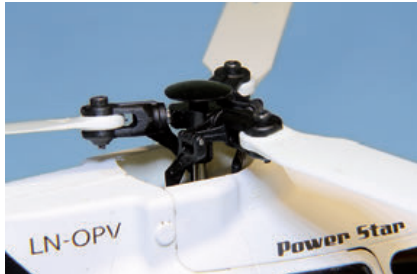
Dreiblatt-Rotorkopf mit Alu-Rotorkopf-Zentralstück
