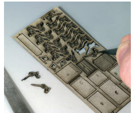
Zunächst werden die Bauteile herausgetrennt und mit der Feile versäubert
