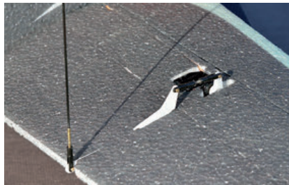
Kunststoffruderhörner werden mit dünnem CA in anzubringende Schlitzte fixiert. Leichtgängig und gut
