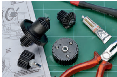
Das vordere Differentialgetriebe ist fertig zum Einbau in das Chassis
