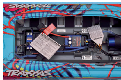
Anlieferungszustand mit vielen Warnhinweisen an Regler und Motor
