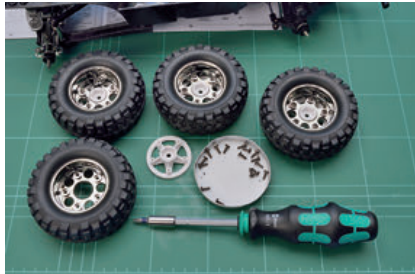
Besonderheit dieser Ausführung: zweigeteilte Felgen, die noch verschraubt werden müssen
