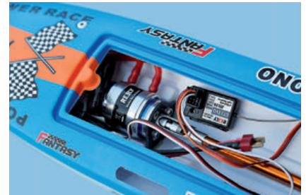
Wassergekühlter BL-Motor mit 3.200 kV, starre Welle fluchtet mit Motorwelle
