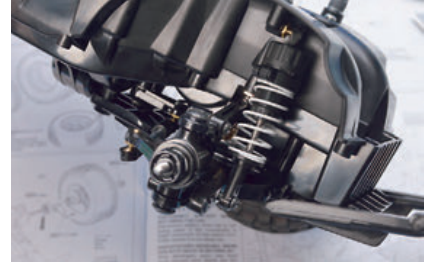
Die Stoßdämpfer werden an Kugelköpfen in den Radläufen montiert
