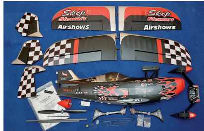
Bis auf das Seitenruder (Sekundenkleber) wird alles gesteckt und geschraubt
