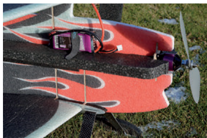
Der kleine 3s-900-mAh-LiPo wird mittels Klett und zusätzlicher Klettschlaufe gehalten. Das Fahrwerk ist aus GFK und CFK, laminiert und in GFK-Frästeilen befestigt, robust mit Schwachstelle
