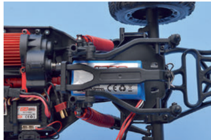
Da ist noch Platz: Entweder man verwendet einen etwas größeren Akku mit mehr Kapazität. Oder man setzt ein Stückchen Moosgummi ein, um das Verrutschen des Kraftspenders zu verhindern
