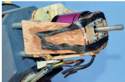
Die Motorhalterung aus Sperrholz und Kohlerovings ist selbst gebaut
