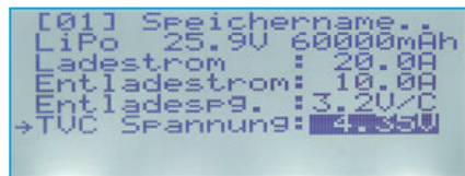
Die Ladeparameter können vom BID ausgelesen oder direkt eingestellt werden. Danach gelangt man durch langes Drücken in das Lade/Entlademenu
