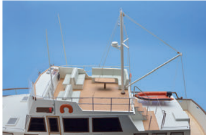
So wird der Mast verspannt. Er lässt sich zum Transport leicht abnehmen. Die Grand Captain passt dann wieder in den Auslieferungskarton
