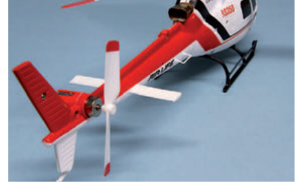
Heckrotor mit Coreless-Brushed-Motor
