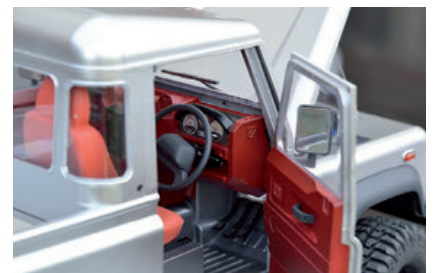
Türen und Motorhaube werden mit Magneten zugehalten. Die Heckklappe ist eingeklipst
