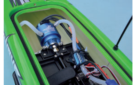
Der 4-polige Brushless-Motor mit 2.000 kV sorgt für ordentlich Vortrieb
