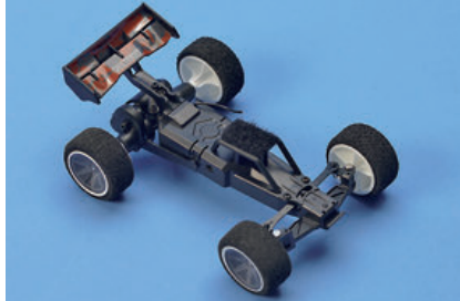
Die Karosserie wird mit einem Stück Klettband auf dem Chassis befestigt
