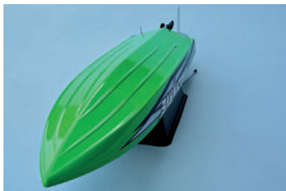
Die Rumpfunterseite mit richtungsstabilisierender Struktur
