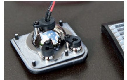
Deckglas, Reflektor und Grundplatte müssen verklebt werden. 3- und 5-mm-LEDs sind vorgesehen
