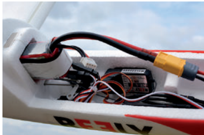
Wenn der Akku ganz im Schacht eingeschoben ist, stimmt auch der Schwerpunkt
