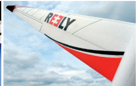
Die schlanken Tragflächen sind mit GFK-Rovings und stabilen Holmen, die Querruder mit einem CFK-Rohr perfekt versteift
