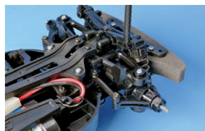
Detail der fertig gebauten Vorderachse
