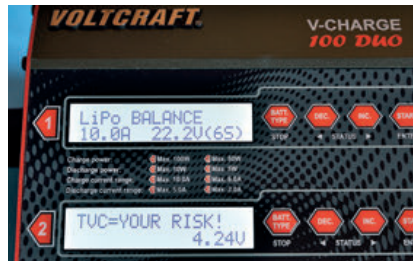
Die Ladeschlussspannung kann bis 4,24 Volt für LiPos eingestellt werden
