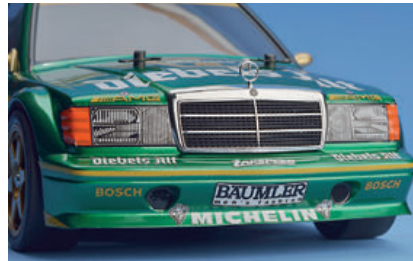
Ein dünner Pinsel und eine ruhige Hand werden benötigt, um die schwarz abgesetzten Flächen des Kühlergrills zu lackieren
