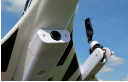
Die Halterung ist für den Einbau einer FPV-Kamera vorbereitet
