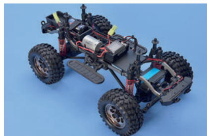
Basis des Mountain Warrior ist ein Leiterrahmenchassis mit einigen Aluminiumteilen
