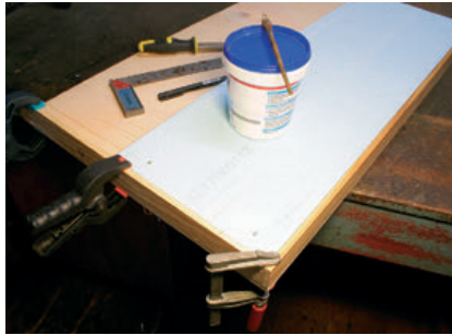
Die Platte erhielt einen hölzernen Abschluss aus einer gehobelten Leiste von 4,5 x 0,8 cm an drei Seiten
