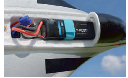
Der Schwerpunkt kann mit dem Akku eingestellt werden
