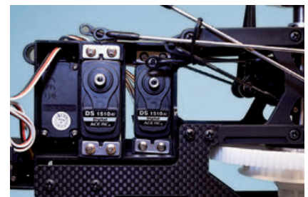
Eingebaute kräftige Digital-Servos und vorgefertigte Gestänge
