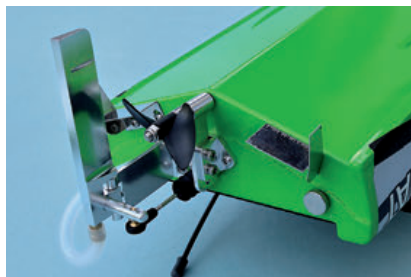
Zwei Leitbleche aus VA müssen, falls notwendig, mit einer Zange justiert werden
