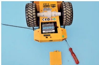
Der NiMH-Akkupack kann im Modell verbleiben, da der Schalter sicher trennt. Zum Laden muss er entnommen werden
