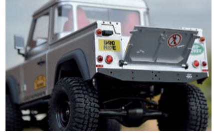
Rücklichter und Blinker sind von innen transparent koloriert und mit Minischrauben 1 x 4 mm befestigt
