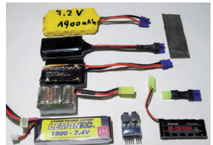
Verwendete Akkus für den Test mit LiPo-Tester, Akku-Adapter und Ausgleichsblei
