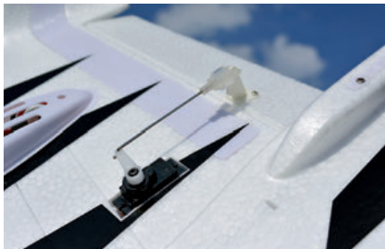
Die beiden Flaps werden von jeweils einem Servo direkt angesteuert
