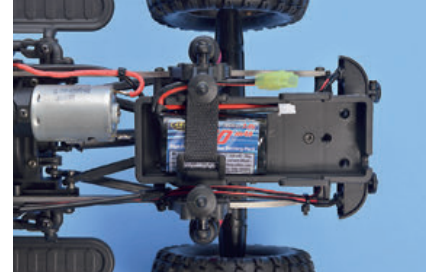
Der Antriebsakku sitzt hoch über der Hinterachse. In dessen Wanne finden auch größere Kraftspender Platz
