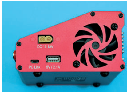
Micro-USB für Ausgang 2. Per XT60-Stecker kann die externe Batterie (Auto) angeschlossen werden
