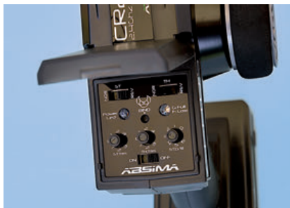
Reverse und Trimm für Gas und Lenkung, selbst Dual-Rate für die Lenkung ist einstellbar
