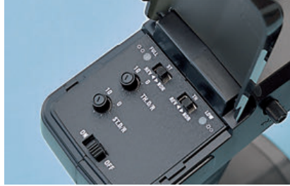
Der 2,4-GHz-ECX-Sender hat neben Trimm- auch Dual-Rate-Funktionen für Gas und Lenkung
