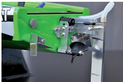
Zum Entleeren kann der Verschlussstopfen am Heck entfernt werden
