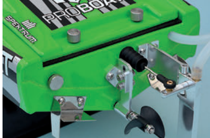
Die Komponenten am Spiegel sind aus hochwertigem Aluminium
