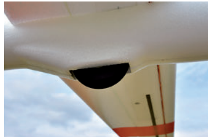
Das große Haupttrud schützt die Unterseite des Rumpfs beim Landen
