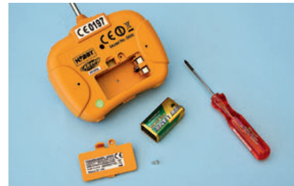
Die Batterie für den Baustellen-Sender liegt bei und verschwindet hinter dem gesicherten Deckel
