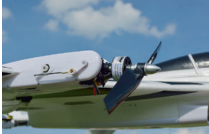
Die Motoren können stufenlos geschwenkt werden
