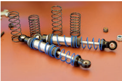
Die Stoßdämpfer müssen überarbeitet werden: Federn tauschen und Silicon-Öl auffüllen
