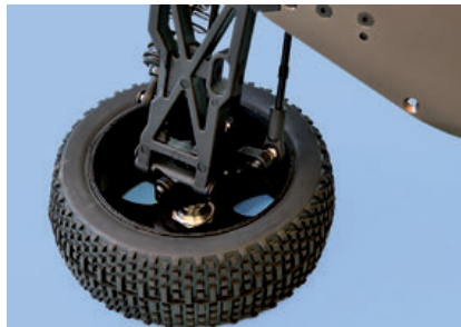
17-mm-Radaufnahmen können das Drehmoment gut übertragen
