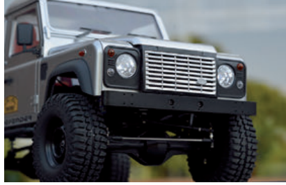
Mit großen Rädern und komplett gesperrtem Abtrieb (keine Differenziale) fürs Klettern geschaffen
