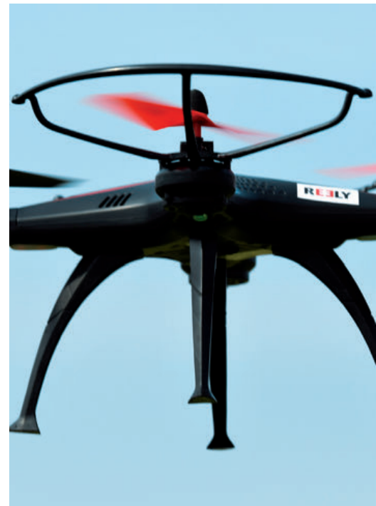
Prop-Guards schützen die Rotoren und die Umwelt!
