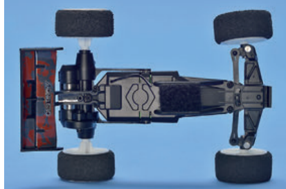
Ein typisches 2WD-Heckantrieb-Chassis. Nur halt viel, viel kleiner als gewohnt
