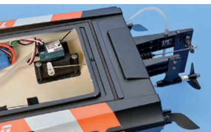
Motor, Regler und RC-Komponenten sind durch die große Luke gut zu erreichen
