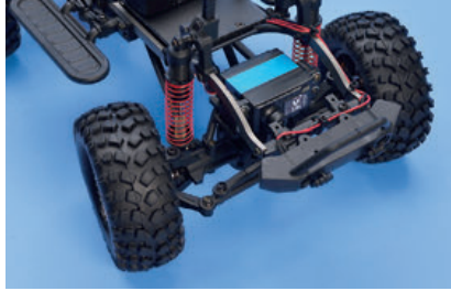
Das Lenkservo sitzt direkt an der Vorderachse
