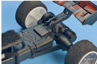
Motor und Getriebe sitzen hinter der von einem zentralen Federelement gedämpften Hinterachse
