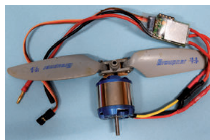
Material für den Brushless-Umbau
