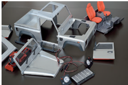
Die Baugruppen sind montiert und liegen bereit für die Hochzeit mit der Karosserie
