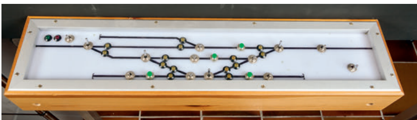
Oben: Das kleine Gleisbild-Stellpult des Bahnhofs Erlenu ist ein vergleichsweise einfacher Eigenbau. Es kann je nach Bedarf an das Bahnhofsmodule angesteckt werden, um den Betrieb vor Ort steuern zu können
