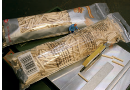
Die Stäbchen werden zugeschnitten, jeweils drei Stück. Sieben Schnitte benötigt man, um eine Stablänge zu verarbeiten
