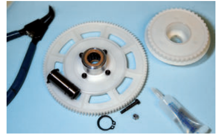
Freilauf des Hauptzahnrad mit Riemenrad
