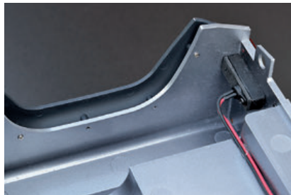
Die beiden fehlenden Schrauben konnten nicht eingedreht werden. LED-Adapter entstanden in Eigenregie
