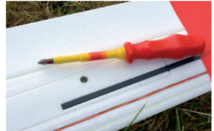
Gesichert wird die Tragfläche am Holm mit einer Kreuzschlitz-Schraube
