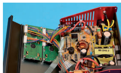
Großzügige Schlitze für den Warmluftaustritt. Kühlkörper sind nicht zu finden
