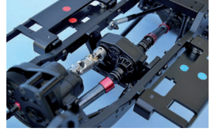
Das zentrale Verteilergetriebe ist selbstverständlich aus Alu und versorgt die Achsen über CVD-Gelenke
