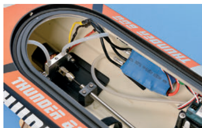
Motor, Regler und RC-Komponenten sind durch die große Luke gut zu erreichen
