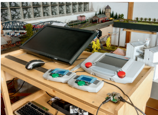
Herzstücke der Digitalsteuerung: Märklins Central Station 2 und ein PC mit dem Steuerungsprogramm Win-Digipet
