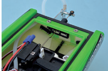
Kunststoffverstärkungen auf der Innenseite, dick eingehärtete Antriebswelle
