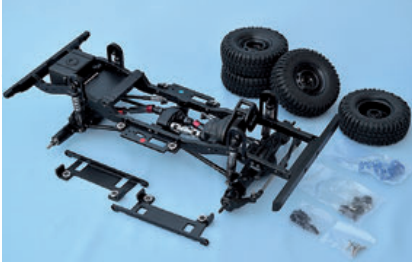
Das Chassis aus massivem, gefrästen Alu mit Stahlgetrieben ist vollständig kugelgelagert
