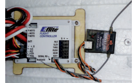
Herzstück der Elektronik ist der Flight-Controller
