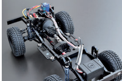
Der Kabelbaum führt in einem transparenten Schrumpfschlauch zur Empfängerbox. Eine saubere Sache
