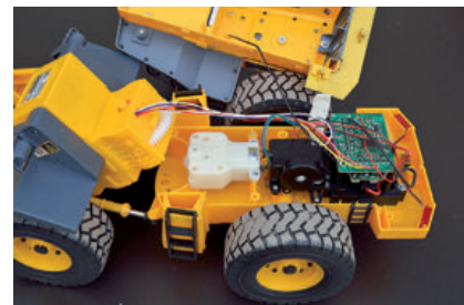
Im Inneren werkeln verschiedene Getriebeneinheiten mit Überlastschutz. 27 MHz mit digitaler Steuerung!
