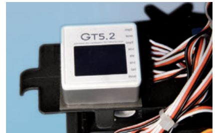
GT5.2, auf Kreiselplattform montiert
