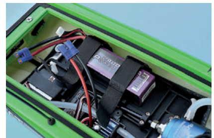
Die Klettschlaufen sind für den 2.400-mAh-Akku zu lang, halten aber
