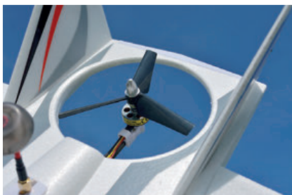
Der Heckmotor ist nur im Copter-Modus aktiv
