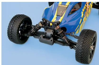
Kunststoff-Federbeine mit Mutter zur Feinabstimmung des Fahrwerkes
