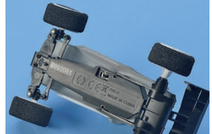
Der Ein-/Aus-Schalter auf der Unterseite ist leicht versenkt untergebracht
