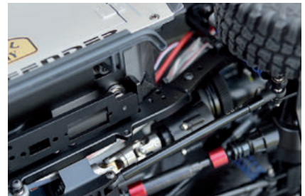
Konstruktionsfehler oder Absicht? Die Magnete der Karosseriehalter sind gegeneinander versetzt
