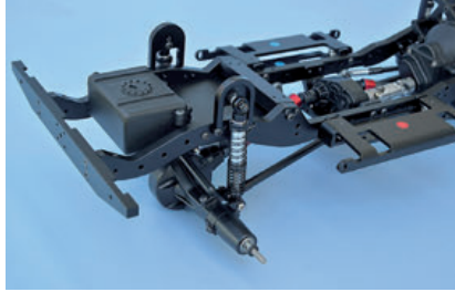
Aus Kunststoff: Empfängerbox und Kugelgelenkungen an den unteren Zugstreben und Lenkungsgestänge
