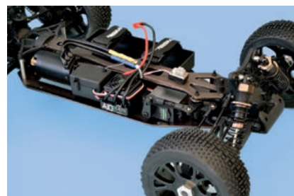
Standard-Anordnung mit stabiler Chassis-Oberplatte aus 2,5-mm-Alu
