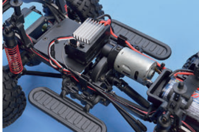
Der Motor mit Zentralgetriebe ist mittig im Fahrwerk montiert. Davor die Empfänger-/Reglerkombi
