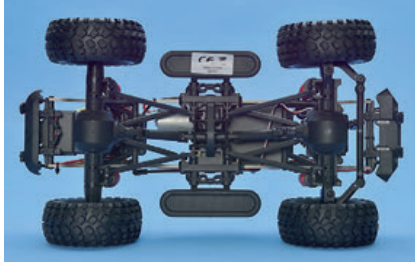
Die Pendel-Starrachsen sind abgestrebt. Sie verfügen über großzügig dimensionierte Differenziale
