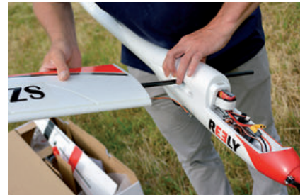
Als Hauptholm kommt ein langes Carbon-Rohr zum Einsatz
