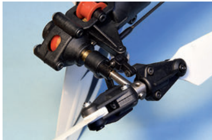
Heckrotor mit „angular bearings“
