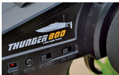
Sind die Schalter am Sender in diesen Positionen, funktioniert die Ansteuerung der Funktionen
