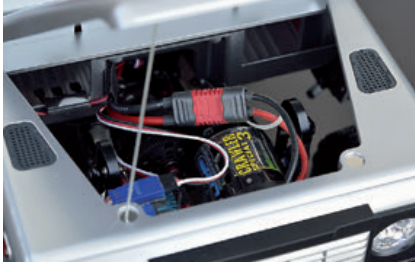
Akku-Verlängerungskabel (T-Plug) und Beleuchtungsanschluss werden im Motorraum gesteckt
