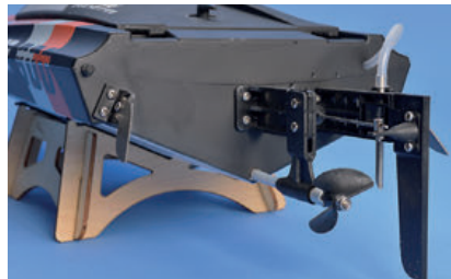
Die Off-Set-Ruderanlage ist, wie der Propeller und die Halterung der Welle, aus Kunststoff. Am Heckspiegel ist noch ausreichend Platz für optionale Trimmklappen
