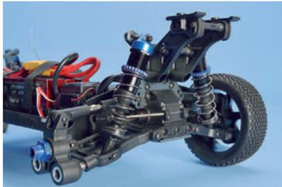
Die Dämpferstangen werden mit Gummihüllen vor Verschmutzungen geschützt
