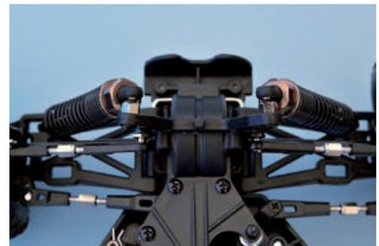
Die elastischen, 5 mm dicken Dämpferbrücken geben dem Druck der Federn nach und sind krumm
