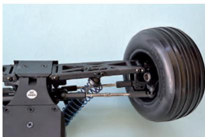
Sturz und Spur sind mit Rechts-/Links-Gewindestangen einstellbar
