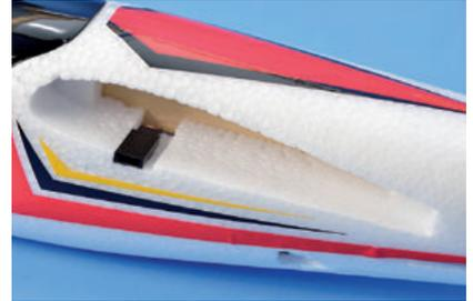
Dank des Servosteckers in der Flächenaufnahme ist der Phoenix XS 2.0 schnell aufgerüstet
