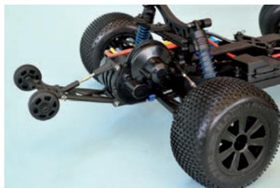
Das Drehmoment begrenzt die Slipper-Kupplung. Die Wheelie-Bar verhindert Überschläge nach hinten
