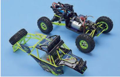
Zum Entfernen der Karosserie müssen acht kleine Schrauben ausgedreht werden
