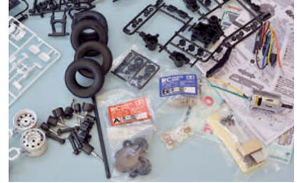
Alle Teile sind mit Nummern versehen. Gleitlager können optional durch Kugellager ersetzt werden
