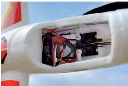
Mit dem LiPo unter der Tragfläche kann der korrekte Schwerpunkt ausgewogen werden
