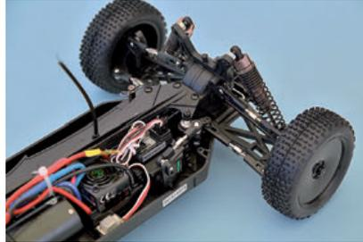
Alles einstellbar: Servo Saver, Spur und Sturz mit Links-/Rechts-Gewindestangen
