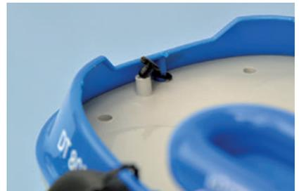
Am Heck ist ein Verschluss zum Entleeren. Eine kleine Restmenge verbleibt und muss trocknen
