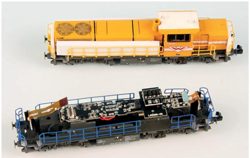
Die Clips der drei Aufbauten stecken recht fest in den kleinen Aussparungen im Unterbau. Beim Zerlegen der Lok sind Geduld und Vorsicht gefordert. Im Vordergrund sieht man die mitgelieferten Zurüstteile für die Pufferträger
