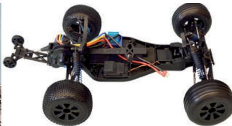
Schlankes Buggy-Chassis mit Heckmotor und Wheelie-Bar
