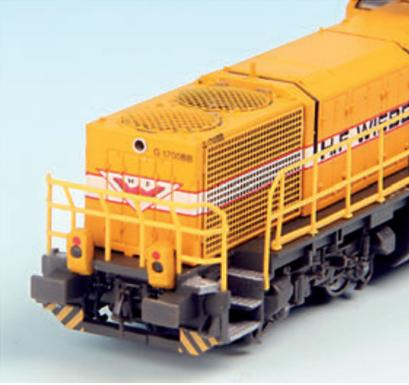
Der vordere Pufferträger ist ab Werk mit einer Nachbildung der Schraubenkupplung und Schläuchen bestückt
