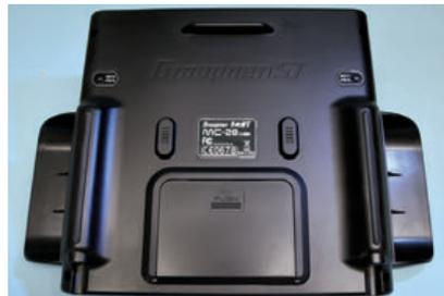
Sender-Rückseite mit den beiden Schaltern
