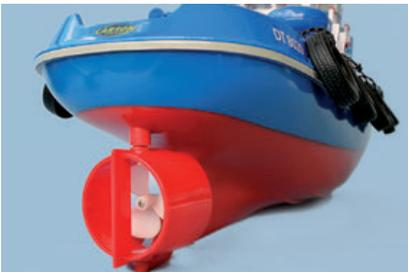
Der Ringschutz (Kortdüse) verhindert Beschädigungen des Propellers und der Finger
