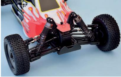
Alu-Öldruckdämpfer können mit Rändelmuttern stufenlos stärker vorgespannt werden
