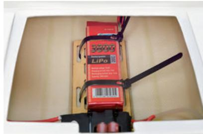
Der Fahrakku wird mit zwei Kabelbindern im Rumpf befestigt
