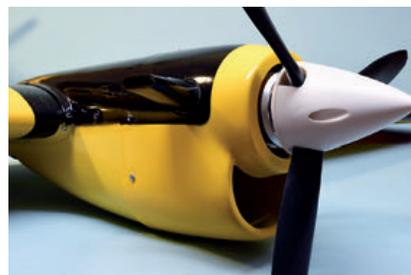
Motorgondel mit großzügiger Lüftungsöffnung
