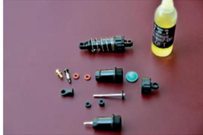
Vollständiger Dämpfer-Bausatz, für unterschiedliche Fahrzeuge mit TT01-Chassis verwendbar
