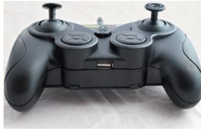
3-Kanal-Sender mit USB-Ladebuchse
