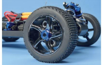
Spur und Sturz werden mit Pivot-Ball durch die Speichen der Felgen eingestellt
