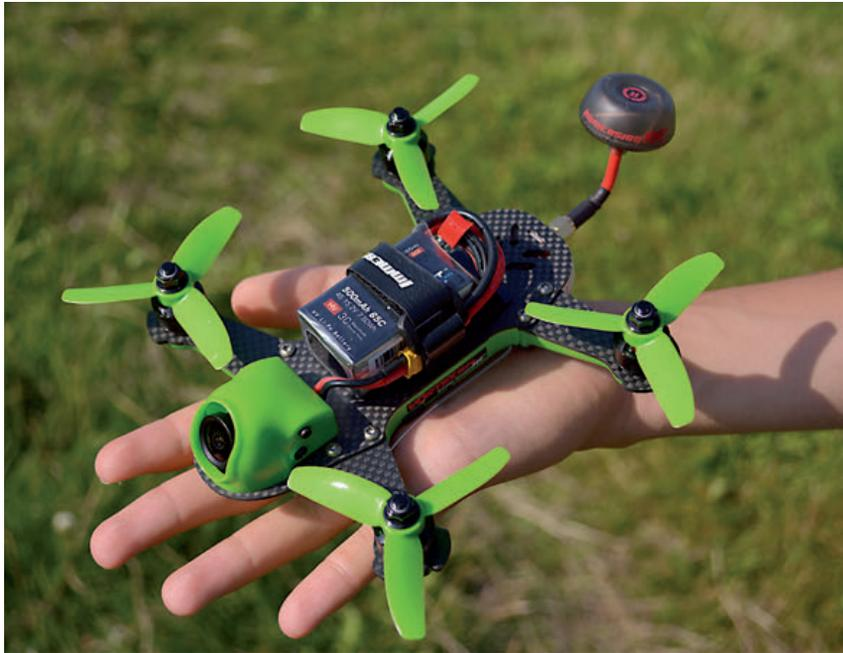
Der Start kann direkt aus der flachen Hand des Helfers erfolgen. Der Pilot sollte stets beide Hände am Sender haben
