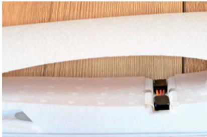
Kabelhalter mit Querruder-Anschlusskabel
