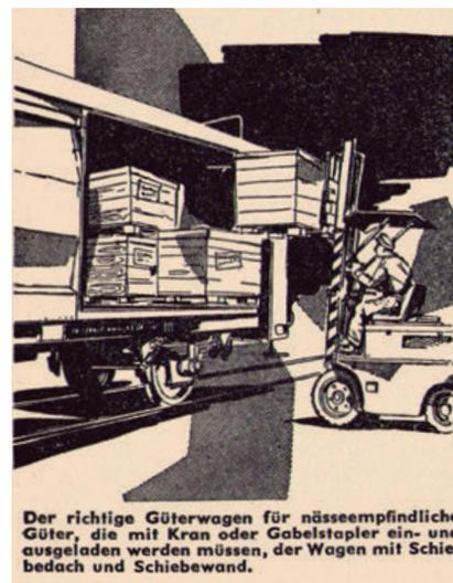
Der richtige Güterwagen für nässeempfindliche Güter, die mit Kran oder Gabelstapler ein- und ausgeladen werden müssen, der Wagen mit Schiebepad und Schiebewand.
