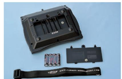
Der 6-Kanal-Sender wird mit den beiliegenden Batterien bestückt
