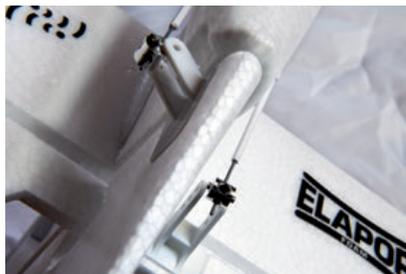
Ausgehängte Kardanbolzen vor Leitwerks-Demontage
