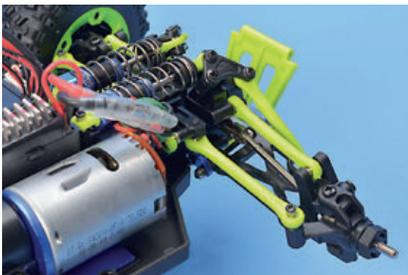
Detail der Vorderachse: Lange Achsschenkel ermöglichen eine breite Spur und viel Federweg
