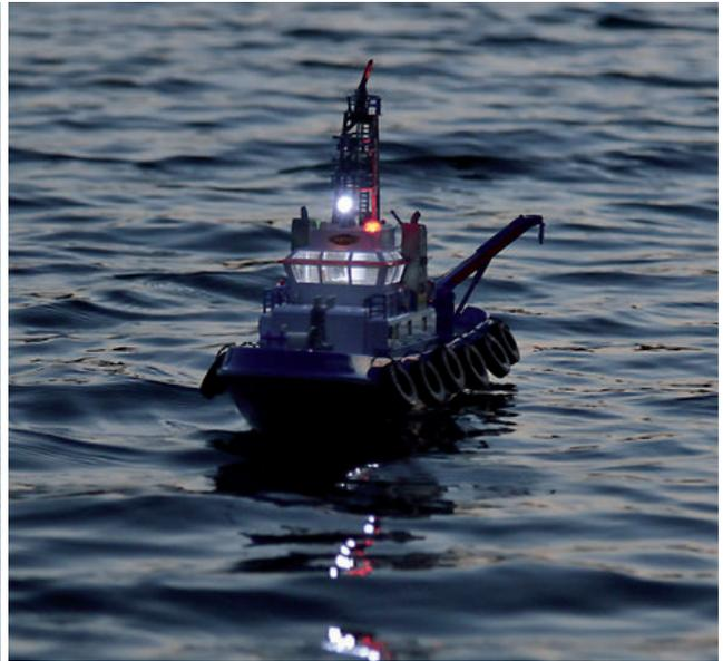
Die Positionslichter leuchten immer. Scheinwerfer und Brückenbeleuchtung lassen sich von der Fernbedienung aus anknipsen
