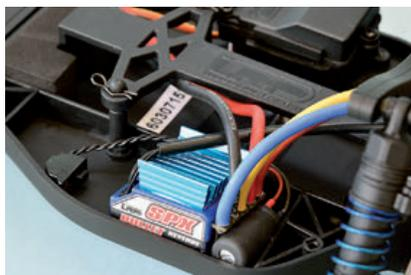
Brushless-Regler mit Sensor-Anschluss sorgt für feinfühliges Fahren
