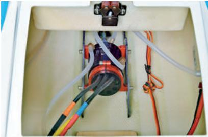
Für Vortrieb sorgt ein wassergekühlter 1.620-kV-Brushless-Motor
