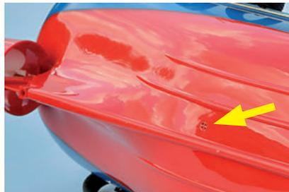
Sieht man genau hin, ist die Öffnung für das Löschwasser zu sehen
