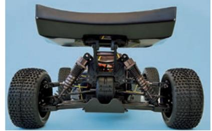
Ist eine andere Fahrwerksabstimmung notwendig, kann die Wirkrichtung der Dämpfer variiert werden
