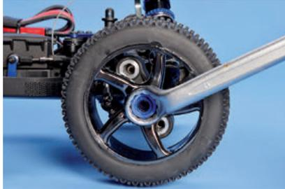
Zum Radwechsel braucht man „richtiges“ Werkzeug: einen 17-mm-Ringschlüssel
