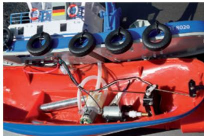
Das Oberdeck ist mit zehn Schrauben und Dichtung aufgesetzt. Weil der Sender keine Reverse-Funktion hat, ist die Ruderanlenkung über Kreuz ausgeführt. Zusatzgewichte sorgen für stabile Lage im Wasser
