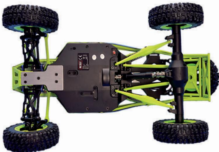
Das Chassis von unten. Vorne ist es von einer Metallplatte stabilisiert, hinten bietet die Starrachse eine große Verschränkung
