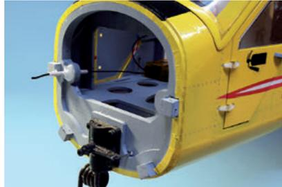
Halterung für 2,4-GHz-Antenne
