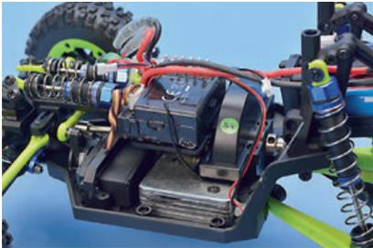
Liegend eingebautes Lenkservo. Darüber der Empfänger mit integriertem Fahrtregler. Metallplatten sorgen für tiefen Schwerpunkt
