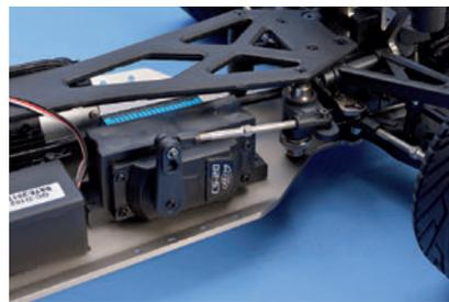
Das kräftige Lenkservo ist wasserdicht
