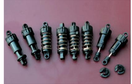
Die Federn der Original-Dämpfer werden gebraucht, um die Öl-Dämpfer zu komplettieren
