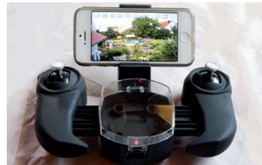
Der Sender ist bereit für FPV-Flug mit Smartphone
