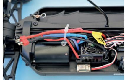
Brushless-Power mit gekapseltem Getriebe und T-Plug. Dank Lüfter bleibt alles kühl
