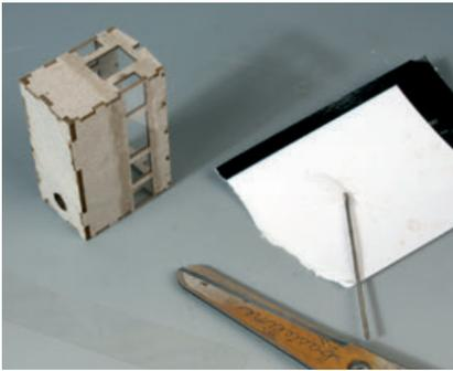
Das Fensterglas wird aus der mitgelieferten Folie ausgeschnitten und von außen aufgeklebt
