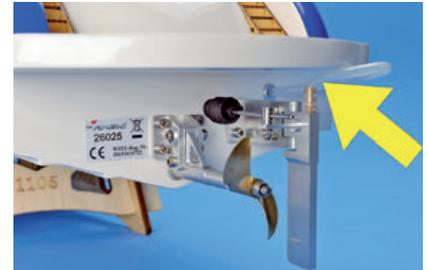
Bei der Montage des Kühlschlauchs muss darauf geachtet werden, dass er nicht geknickt wird
